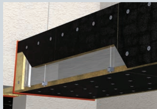
Detail der Kanalverbindungsstellen und Aufhängungen.
