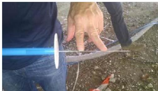
**Figure 5 : Pige de mesure de l'épaisseur**
