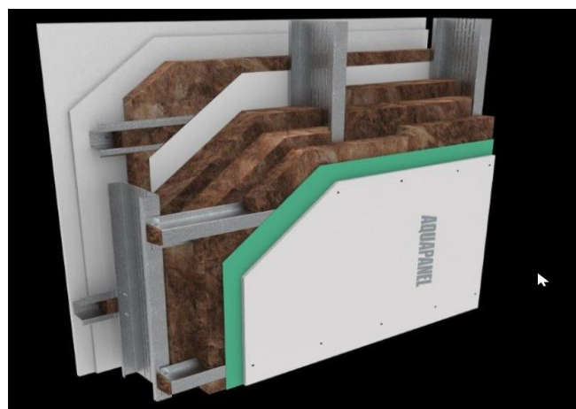
Рисунок 10 – Конструкция каркасной стены с дополнительным слоем теплоизоляции
