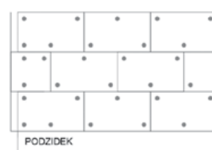
3 pritrčila/ploščo oz. 5 pritrčil/m 2 fasade – shema W
