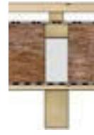
Nadkrovové zateplenie pre novostavby i rekonštrukcie. Výšku vrstvy izolácie nad krovkami možno navrhovať do úrovne 320 mm. V závislosti od hrúbky skladby a zvoleného typu tepelnej izolácie možno dosiahnuť výslednú hodnotu súčinitela prechodu tepla až  $0,11 \text{ W/m}^2\text{K}$ .
