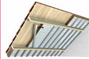
STAP 2 - Staanders en isolatie plaatsen
